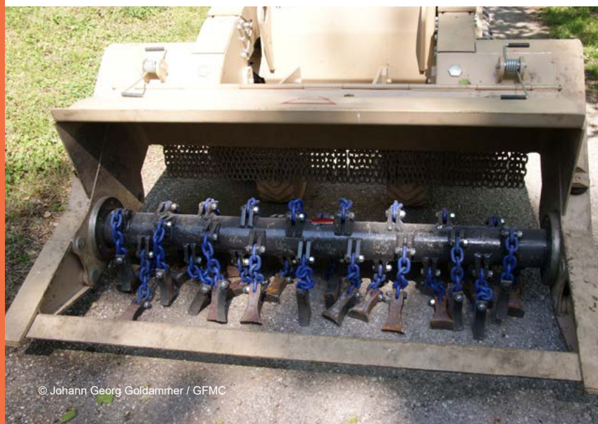
Рис. 1.1. Приклад безпілотного трактора призначеного для проведення розмінування території.
