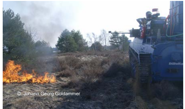
Рис. 4.12. Технічні засоби для проведення контрольованого випалювання горючих матеріалів на територіях забруднених ВВП. Технологія розроблена Глобальним центром моніторингу пожеж (GFMC), Німеччина.
